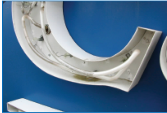
◀ Figura 5: Annerimento e distacco delle polveri in questo dettaglio; sono presenti anche macchie in prossimità degli elettrodi
