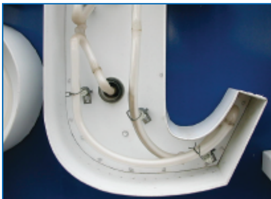
► Figura 4: Si noti l'annerimento in vicinanza del supportino e nella giuntura
